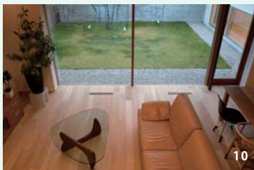
9 ロフトにより縦方向の開放感が生まれる。10 窓付近の床には通風孔があり、 ロフトのエアコンから送り出された空気が循環。11 プライバシーと開放感を両立。
